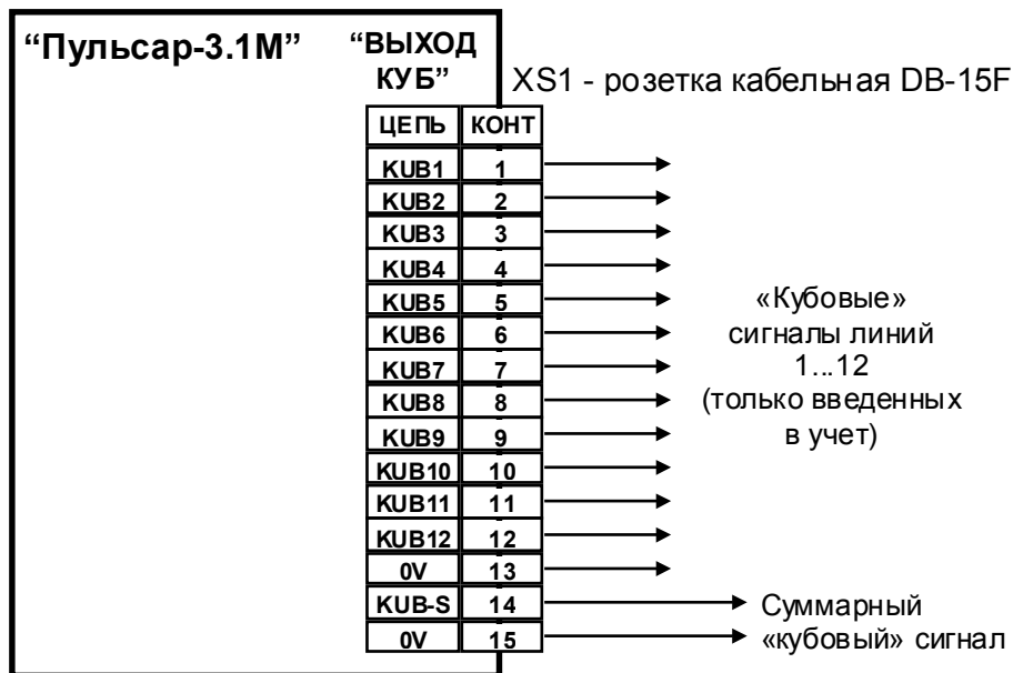
Рис. 7. Подключение вторичных приборов к соединителю "ВЫХОД КУБ"
